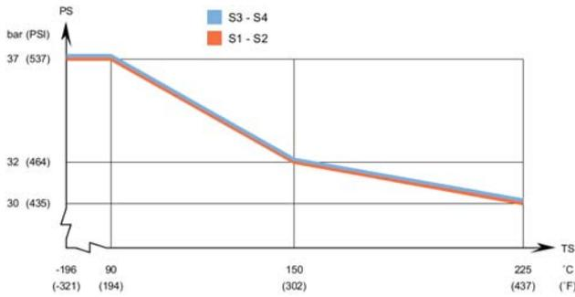
**CBH112 - DGRL-Prüfung, Druck-/Temperaturdiagramm\***
